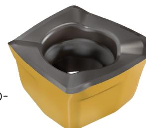
Beim Einsatz der WSP in einem **HELI4MILL**-Werkzeug zum Hochvorschubfräsen, sind die Plattensitze einem Radius von 2 mm zu modifizieren.
