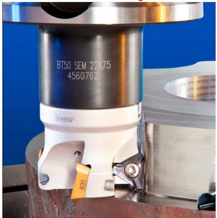
**HELIIQMILL 390**-Werkzeuge sind für Wendeschneidplatten mit den Schneidkantenlängen **10** und **15 mm** verfügbar.
