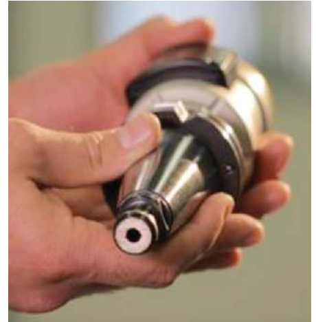
Werkzeughalter mit Kühlmittelbohrung
